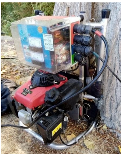
Foto 1: Generador de corriente
